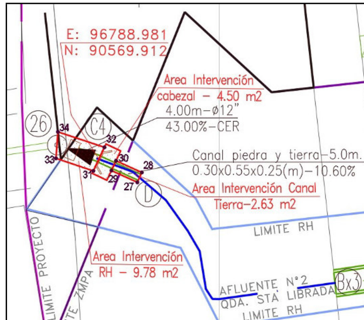
Ilustración 15. Polígono de obra de Cabezal 4 y Colector
